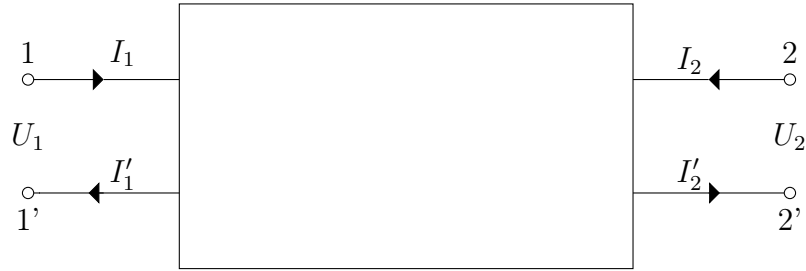
2.1. ábra. 2-port hálózat sematikus rajza
